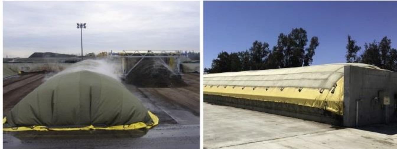
Figura 7: Ejemplos de sistemas de aireación forzada. Fuente: The Composting Handbook (Rynk, 2022).
